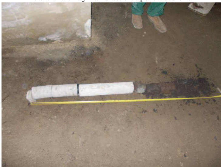
Obr. 8 Sonda do podlahy a základu v suterénu
