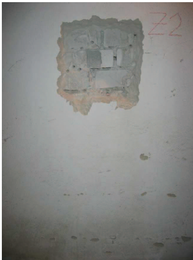
Obr. 4 Sonda na nosném zdivu v suterénu, zjištění pevnosti a vlhkosti
