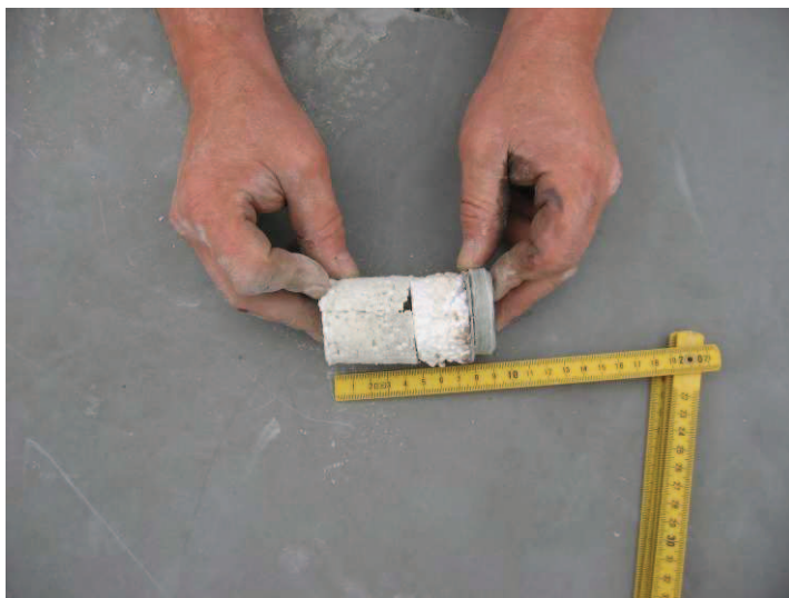
Obr. 15 Sonda do střešního pláště
